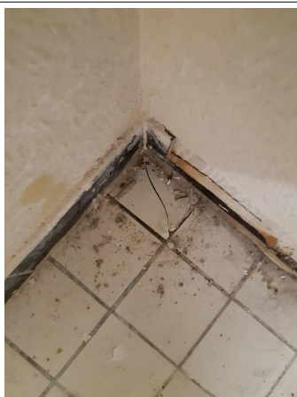
Prélèvement - P027 : R+1 / Zone cuisine / Réserves 2 - Colle- (Absence d'amiante)
