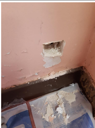
Prélèvement - P005 : R+1 / Zone Accueil et salle restaurant - Panneau de cloison- (Absence d'amiante)
