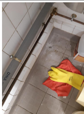
Prélèvement - P022 : R+1 / Zone cuisine / Réserve / Coin cuisine - Colle- (Absence d'amiante)
