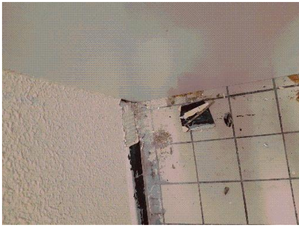
Prélèvement - P029 : R+1 / Zone cuisine / Réserves 2 - Colle- (Absence d'amiante)
